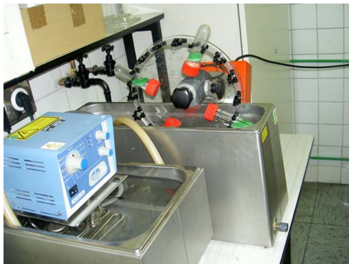
Figura 5.4. Montaje experimental para el procedimiento de agitación combinada rotatoria-ultrasonidos.
