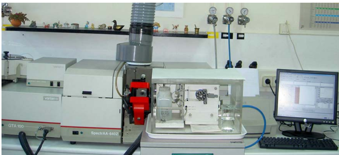
Figura 3.1. Espectrómetro Varian SpectrAA-640Z con accesorio de generación de vapor frío de Hg VGA-77.
