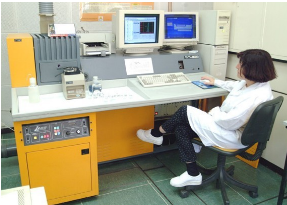
Figura 3.4. Espectrofotómetro de ICP-AES Jobin Yvon modelo JY38PLUS
