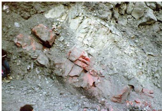
Figura 8.2. Capa de cuarcita mineralizada con cinabrio (rojo) en la mina de El Entredicho. Fuente: [3]
