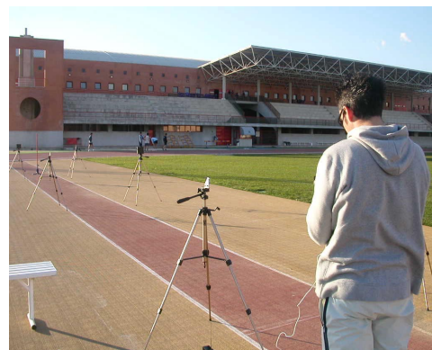
Figura 5 Ubicación Barreras fotoeléctricas
