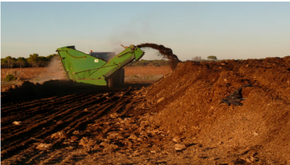
Figura 9. Proceso de volteo de CAC una vez finalizada la última fermentación.
