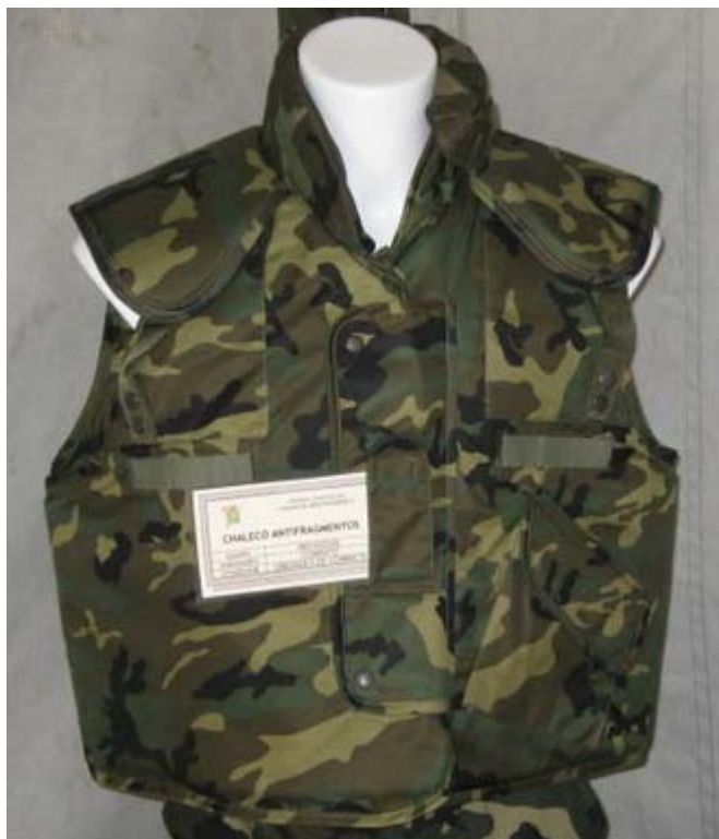
Figura 18: Chaleco antifragmentos de dotación en el Ejército de Tierra español. V_{50} 600/710 m/s. Densidad superficial 8-9 kg/m 2 .
