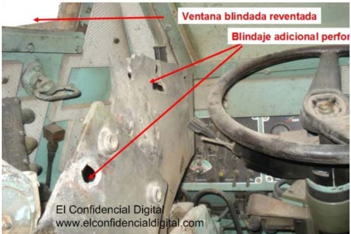
Figura 25. Blindado Medio sobre Ruedas español tras ataque suicida el 9 de Noviembre de 2008 en las cercanías de la ciudad de Farah. www.elconfidencialdigital.com
