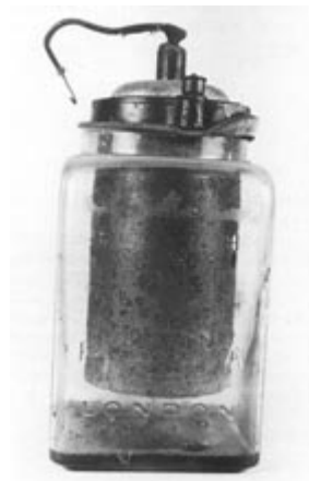
Figura 1.5. La pila seca de Leclanché .
