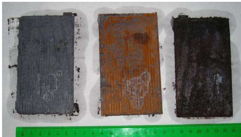
Figura 4.35. Detalle de placa positiva, negativa y el separador. Prototipo preparado con el Compuesto SP2 (4% SiO 2 ), después de 19500 microciclos Stop&Start .
