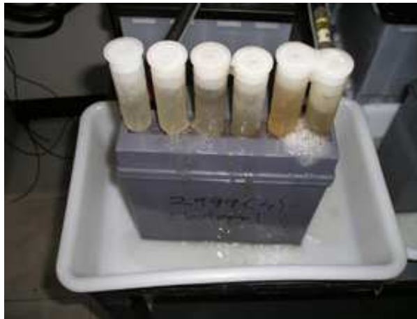
Figura 3.21. Detalle del dispositivo para evitar la pérdida de electrolito durante el proceso de formación.
