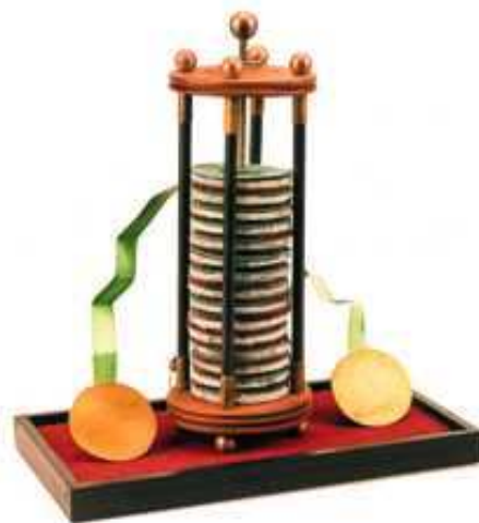
Figura 1.2. Pila de Volta
