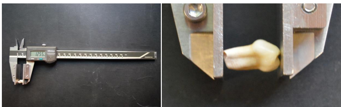
Figura 3: Calibre Mitutoyo Digimatic 500 series modificado para la obtención de la longitud máxima de los gérmenes dentales en calcificación.
