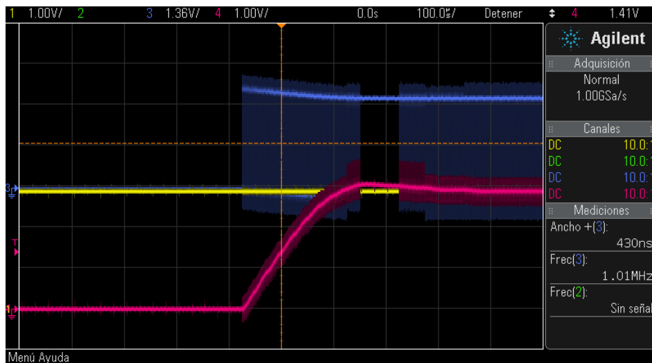
Figura 21: Captura de osciloscopio para el circuito RLC1. La línea amarilla es la consigna, la azul es el PWM y la rosa es la salida de la planta
