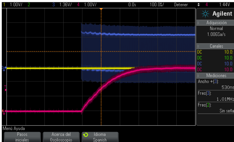
Figura 25: Captura de osciloscopio para el circuito RC1. La línea amarilla es la consigna, la azul es el PWM y la rosa es la salida de la planta
