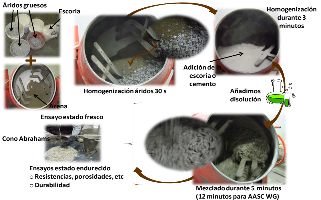
Fig. 8.1-1 Esquema de la preparación de los hormigones de escoria activados alcalinamente con las diferentes disoluciones y el hormigón OPC (Universidad de Sherbrooke, Québec, Canadá)
