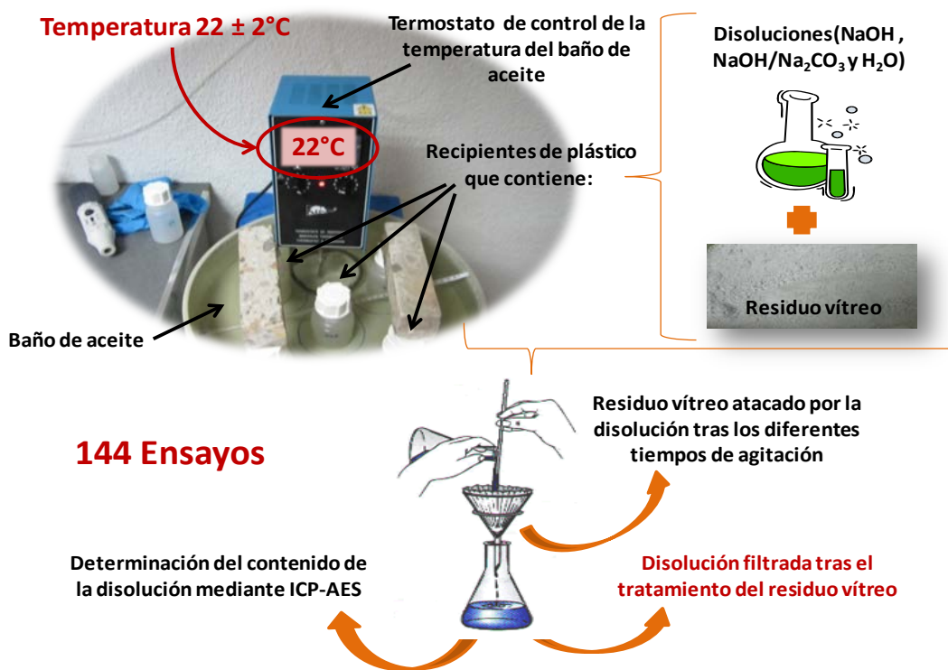
Fig. 5.2-1 Esquema del montaje para el proceso de solubilidad química a temperatura ambiente (22 ± 2°C)
