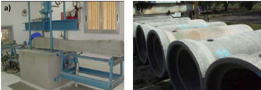
Fig. 2.1-9 Hormigones de ceniza volante activadas alcalinamente a) Traviesas de ferrocarril (Palomo et al., 2004a); b) Tubos para la red de alcantarillado (1500 mm de diámetro) (Gourly and Johnson, 2005)
