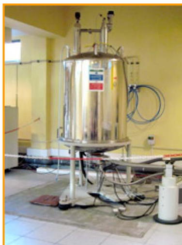
Fig. 3.1-11 Espectrómetro de resonancia magnética nuclear, Bruker MSL 400 (Instituto de Ciencias de Materiales de Madrid, CSIC)
