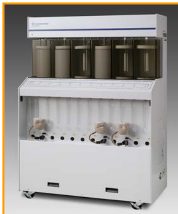
Fig. 3.1-5 Equipo de isoterma de adsorción ASAP 2420 Micromeritics (Instituto de Catálisis y Petroquímica, CSIC)
