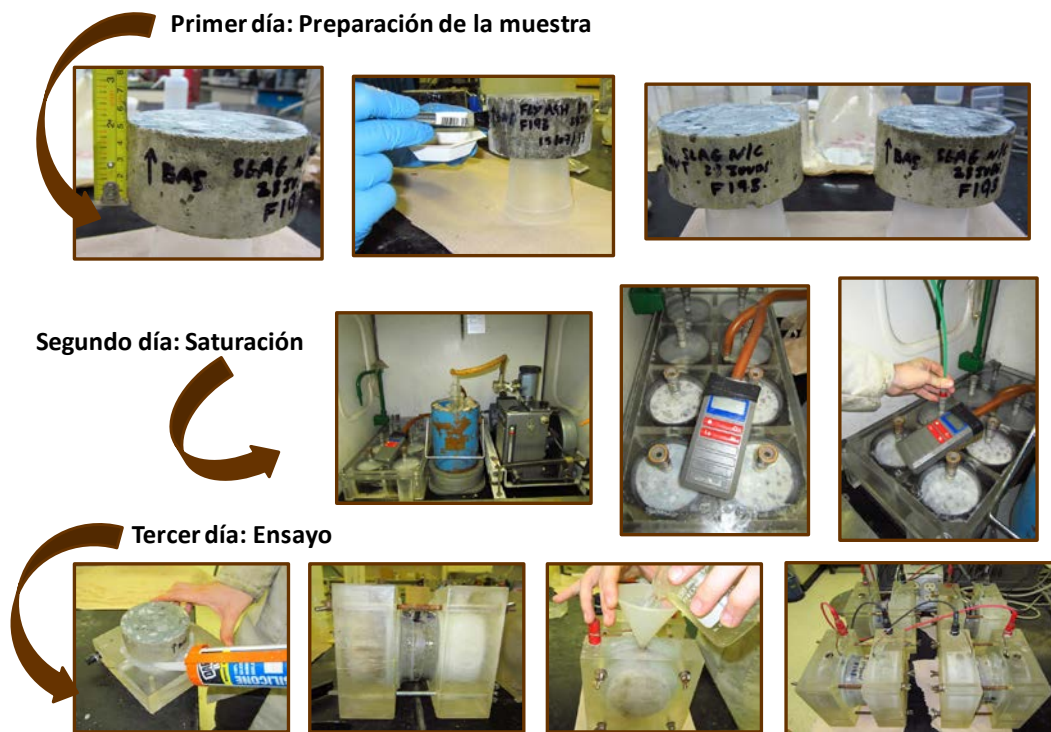
Fig. 8.3-1 Montaje del ensayo de penetración de cloruros en hormigones (ASTM C1202)
