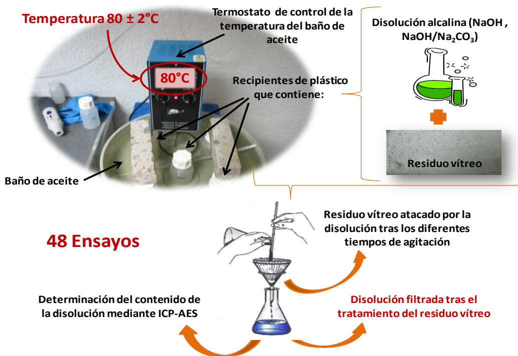
Fig. 5.2-2 Esquema del montaje para el proceso de solubilidad química con temperatura ( 80 \pm 2^\circ\text{C} )
