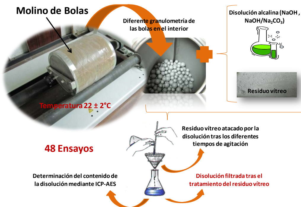
Fig. 5.2-3 Esquema del montaje para el proceso de solubilidad Mecano-Química a temperatura ambiente ( 22 \pm 2^\circ\text{C} )
