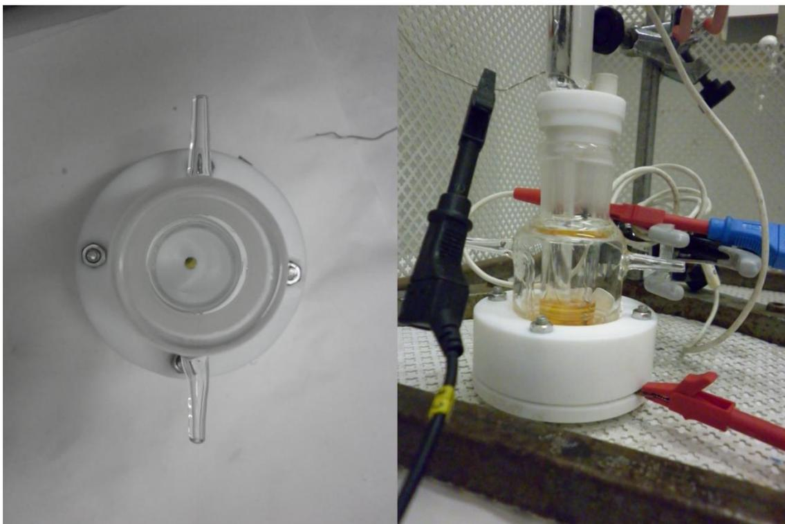
*Figura 15- Celda electroquímica utilizada con electrodos de trabajo planos.*
