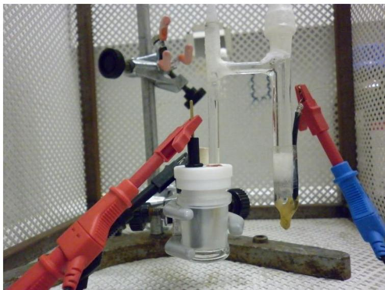
*Figura 14-Celda electroquímica de tres electrodos.*
