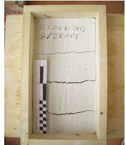
Fig. 8. Pieza de mortero fraguada realizada con cal grasa, arena y agua, donde se pueden observar claramente las fisuras que se han producido
