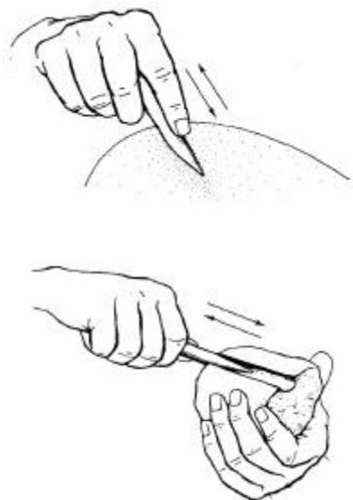
Figura 75: Técnica de abrasión realizada sobre una piedra abrasiva con superficie lisa (Camps-Fabrer y D'Anna 1977, fig. 6)
