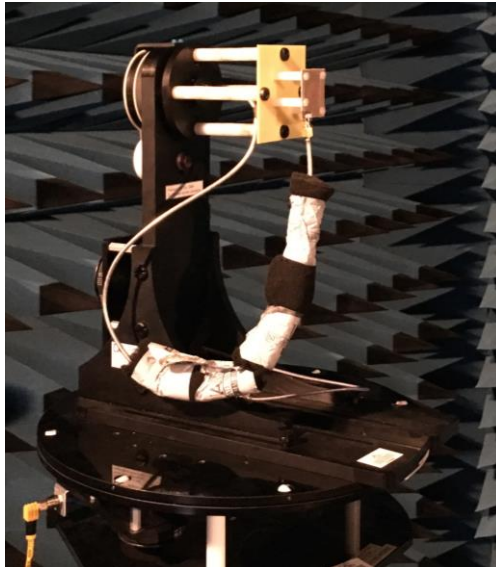
Figura F-15 El elemento sobre el soporte ya situado en la cámara anecóica
