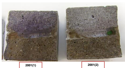
Figura 54. Frente de cloruros. Lote 1 y acero dúplex 2001.
