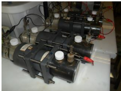
Figura 48. Sistema de ensayo para el método acelerado "multirrégimen".
