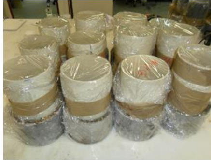
Figura 50. Preparación de las probetas para el método natural Ponding.
