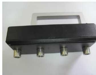
Figura 47. Resistímetro portátil. Método de Wenner.
