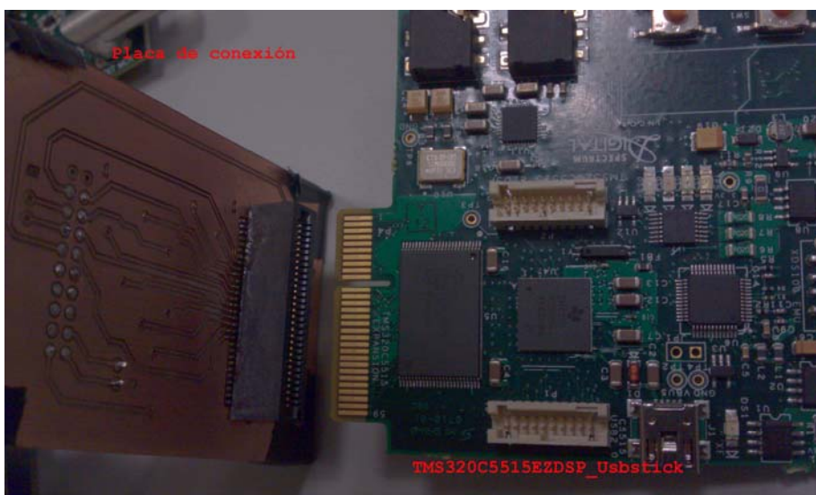
Figura 22. Conexión entre C5515 y placa de conexión
