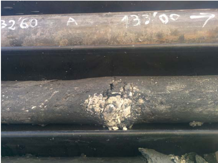
Foto 4.10. Testigo de gouge del sondeo FAM-1 a una profundidad de 133 m, donde destaca un clasto de cuarzo pulverizado que ha experimentado dilatación, deformando los bordes del testigo y abriendo fracturas.
