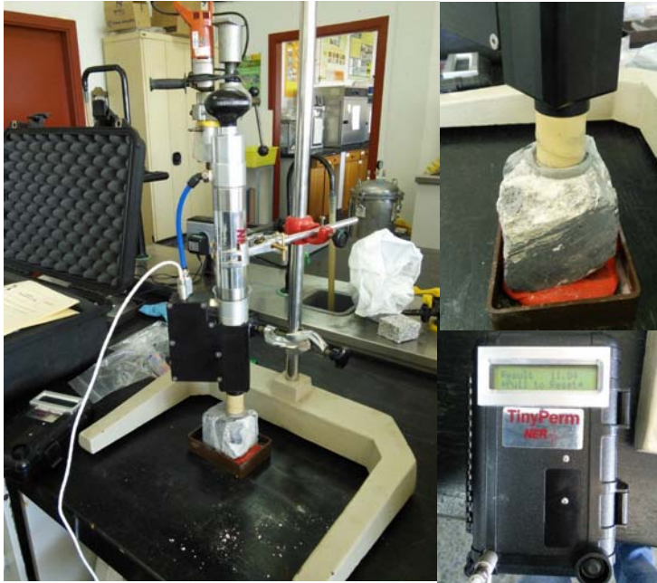
Foto 5.4. Experimento de medición de permeabilidad al aire.
