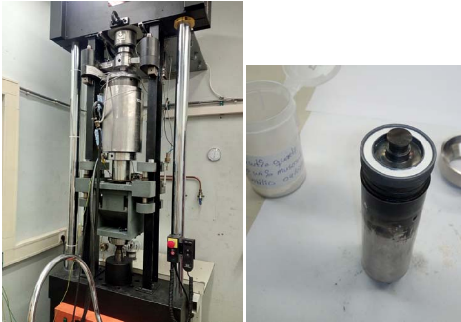
Figura 5.1. Aparato de cizalla rotacional del HPTlab de la Universidad de Utrecht. A la derecha muestra preparada para experimentar.
