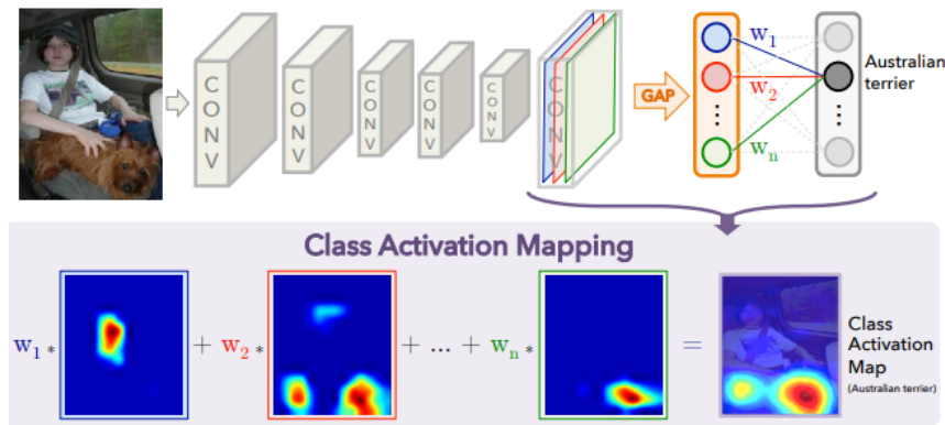
Figura 2.5: Esquema de la extracción del mapa de activación de una imagen. Se observa que antes de la última capa, se obtienen los pesos de la capa anterior para extraer el mapa de activación. Adaptada de [17].
