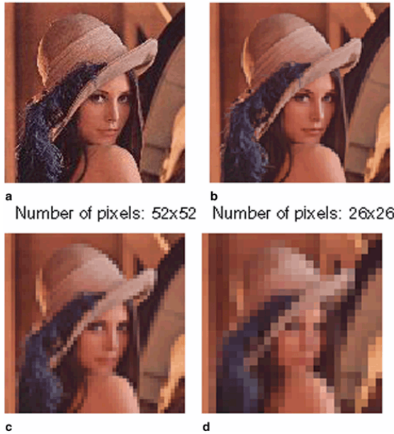
Figura 2.2: Concepto de resolución de una imagen. De mayor la foto a , a menor resolución de imagen la foto d . [2, pág 7]
