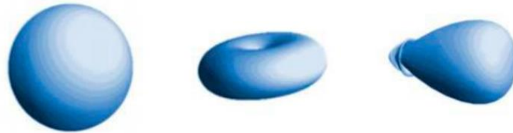
Figura 2-9 Diagramas de radiación: a) Isotrópico b) Omnidireccional c) Directivo
