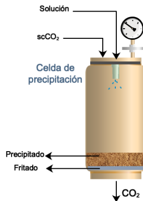
Figura 1.5. Diagrama de la celda de precipitación supercrítica antisolvente (SAS).
