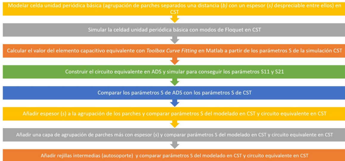
Figura 4-1: Esquema de los pasos realizados para la construcción del modelado circuital de la Figura 3-8.
