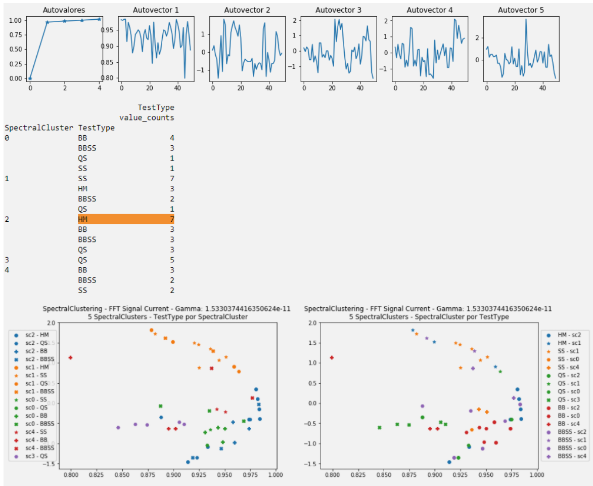
Figura 3.15: Clusters generados por SC a partir del espectro de frecuencias de la señal escalada filtrada a 200 Hz del conjunto de pruebas básicas
