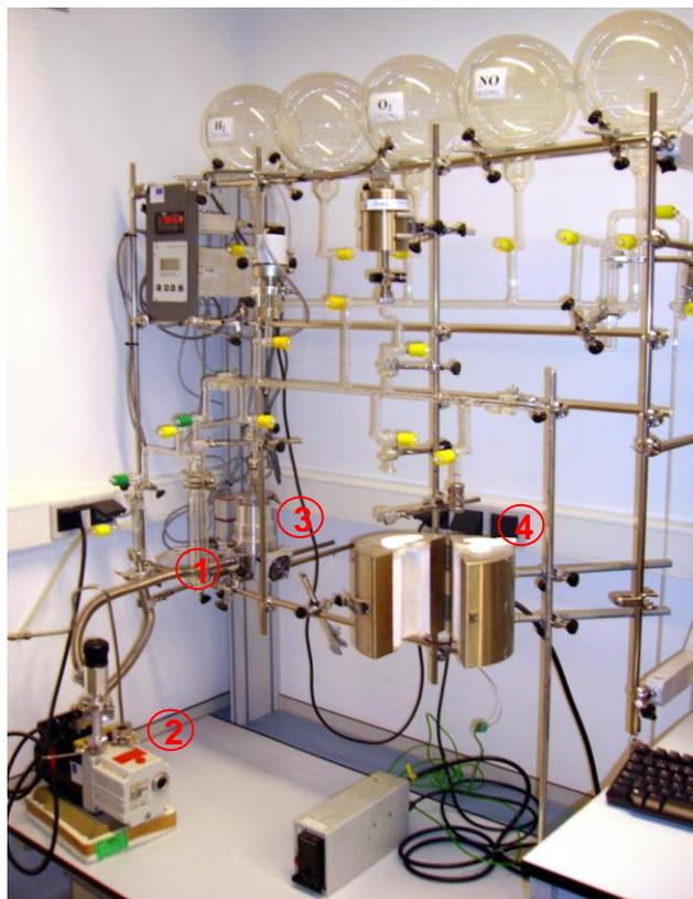
*Figura 3.7. Línea de vacío empleada en la activación del catalizador.*
