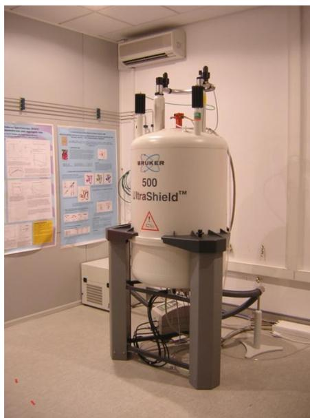
*Figura 3.15. Espectrómetro Bruker Avance 500.*
