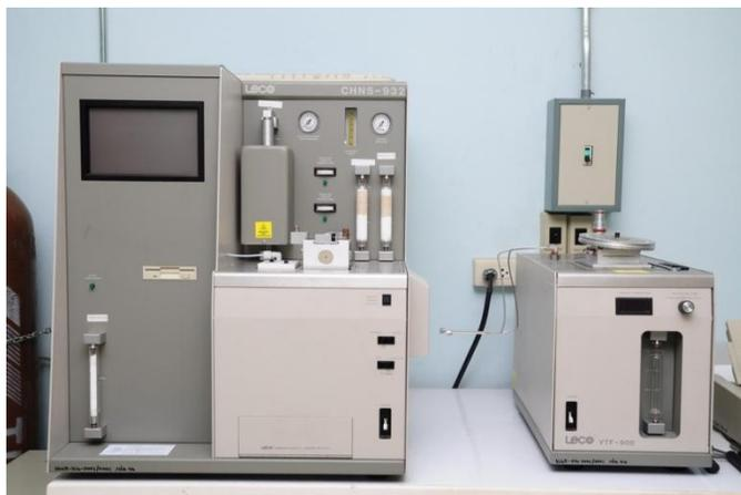
*Figura 3.16. Analizador elemental LECO CHNS-932.*
