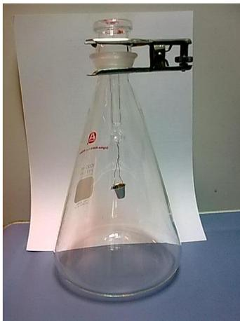
*Figura 3.17. Matraz de combustión para el análisis de S.*
