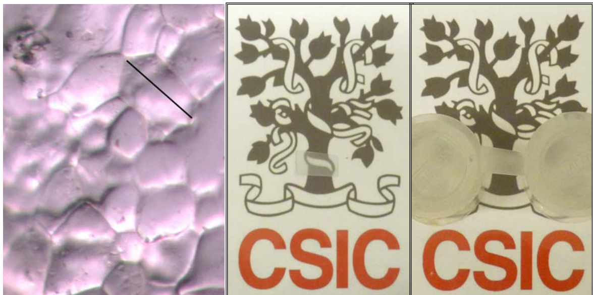
Figura 3. a) Imagen de la microestructura de la muestra sinterizada durante 8h a 1725^\circ\text{C} en Hidrógeno obtenida mediante un microscopio óptico. b) Aspecto exterior de la muestra sobre la figura. c) Aspecto exterior de la muestra situada a 2cm de la figura.
