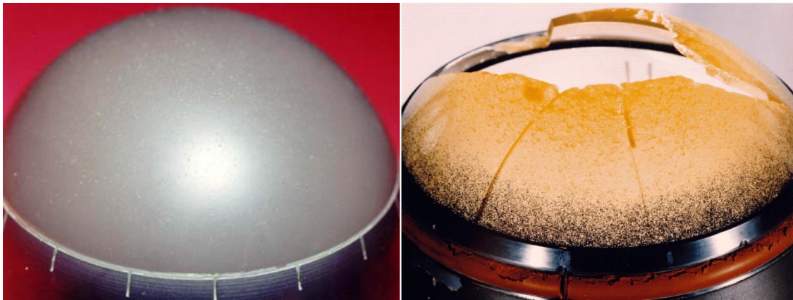
Figura 1. Ventana al infrarrojo de sulfuro de zinc rota por el impacto de zinc y ventana de fluoruro de magnesio deteriorada por el impacto de partículas atmosféricas.
