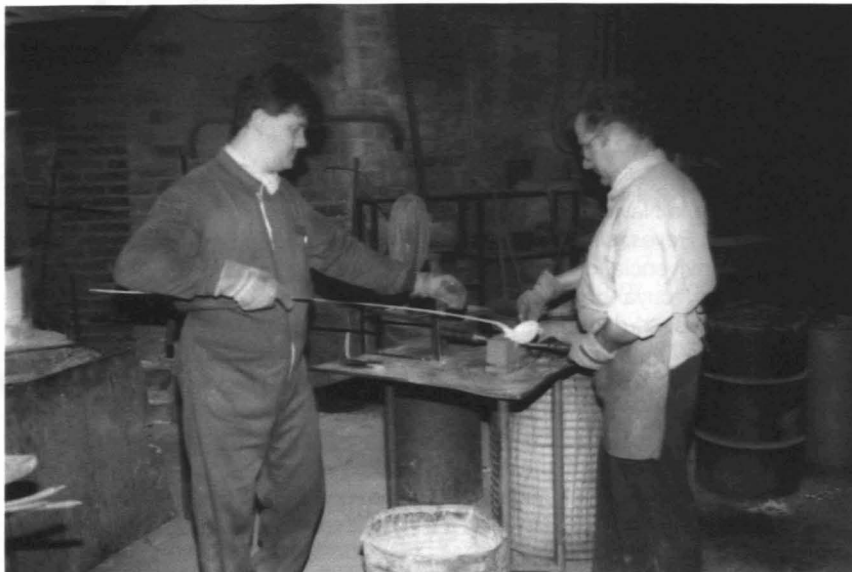
Fig. 8: Trabajo en el taller Maillo en el momento de verter el metal fundido en la coquilla.
