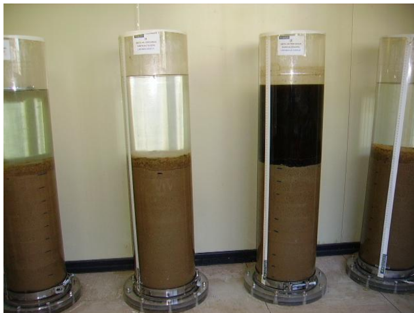
Foto 2.2 Columnas de Bailén montadas con los lixiviados L3, L1, L4 y L2, respectivamente.
