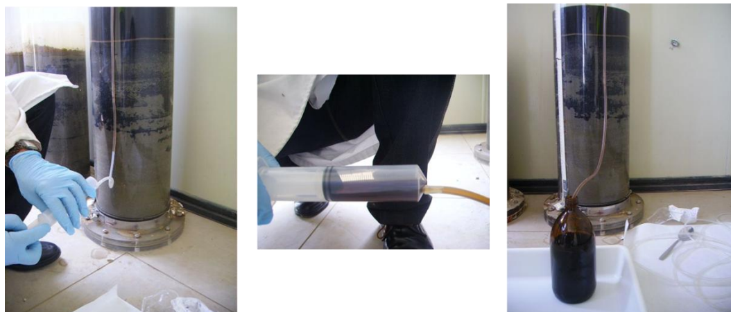
Foto 2.9 Extracción del lixiviado L4 después del experimento.
