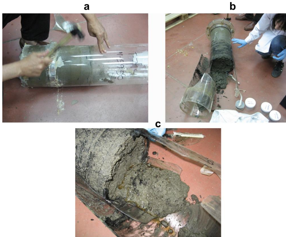
Foto 2.11 Rotura de las columnas a) L1, b) y c) L2.
