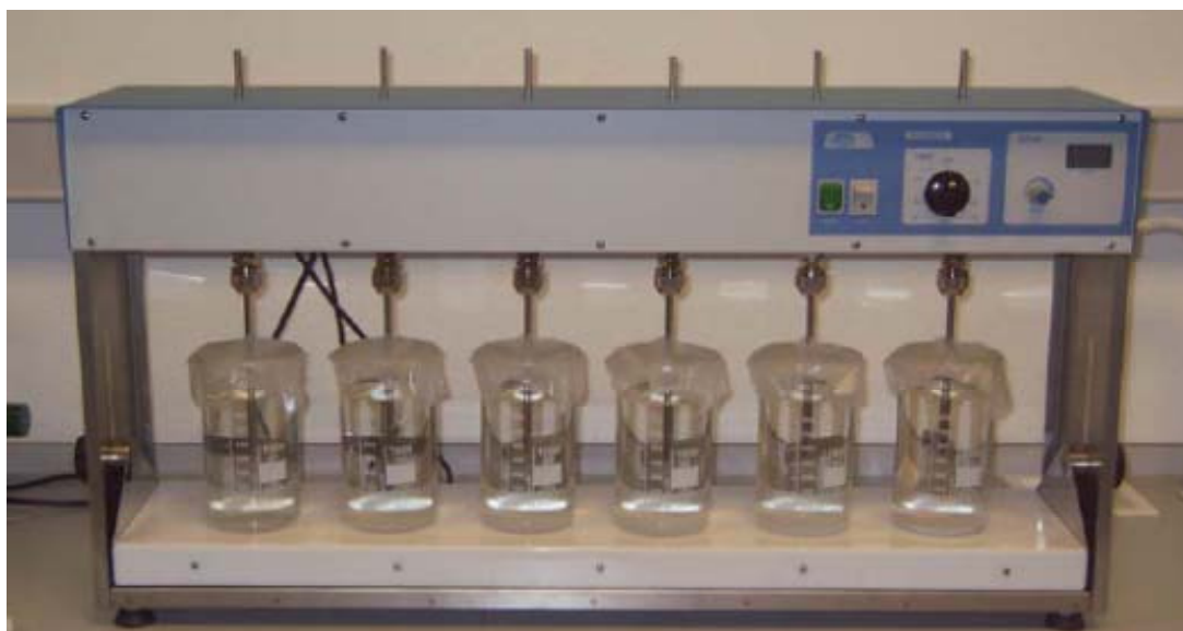
Figura 2.2. Instalación experimental empleada en el pre-tratamiento de aguas reales de proceso.
