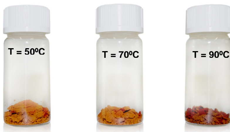
Figura 5.12. Sólidos formados al final de la reacción de oxidación para las distintas temperaturas iniciales de operación ensayadas.
