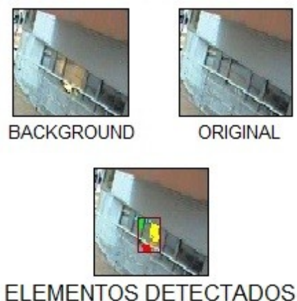
Figura 3-9: Respuesta del sistema ante la desaparición de una fuente luminosa
