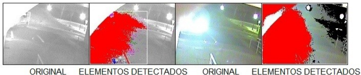
Figura 3-14: Cambio de la cámara a modo diurno causado por un alumbrado intenso. Generación de alarma de tipo “obstrucción”
