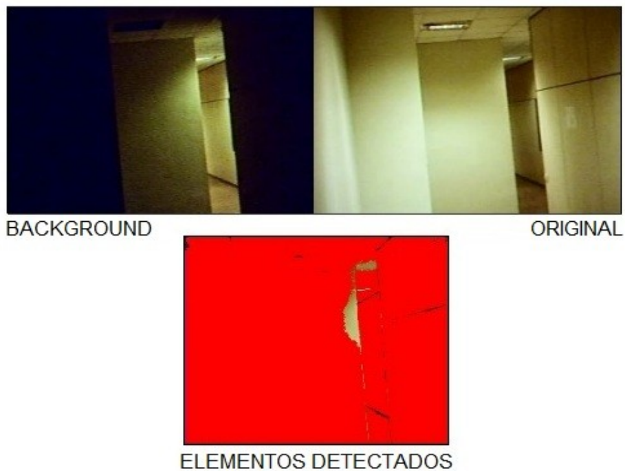
Figura 3-6: Respuesta del sistema ante un cambio de iluminación muy brusco
