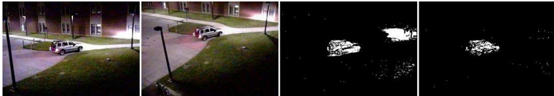
Figura 2-13: Detección de cambios de iluminación utilizando dos vistas. De izquierda a derecha: vista de referencia, segunda vista, detección con una cámara y detección con dos cámaras. [27]
