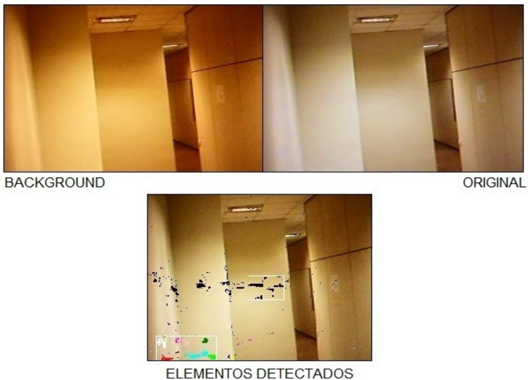
Figura 3-4: Respuesta del sistema ante un cambio de iluminación leve
