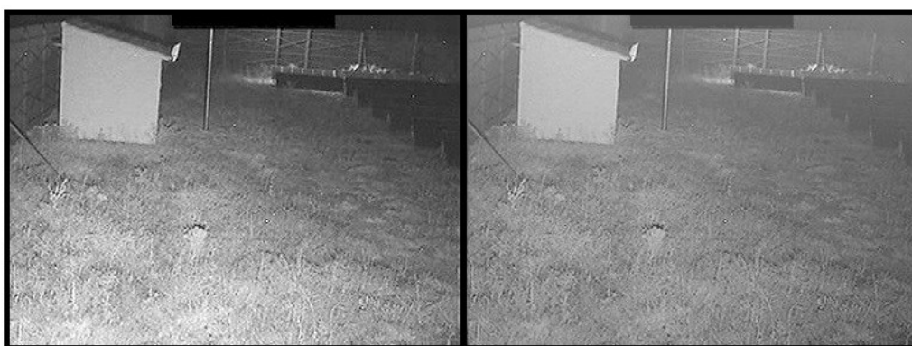
Figura 4-9: Imagen original e imagen tras la corrección del gradiente de iluminación
