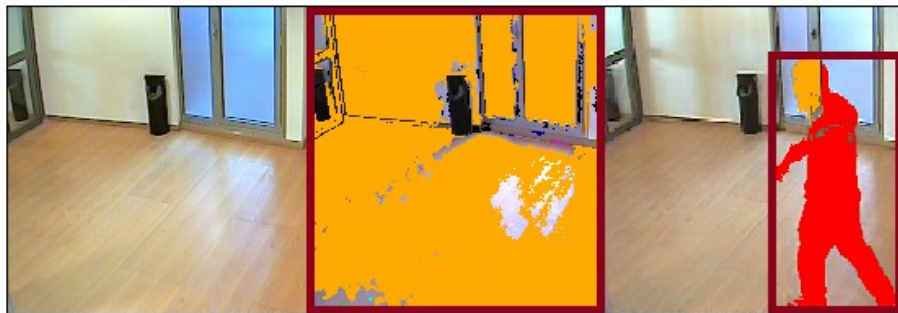
Figura 4-12: Comparativa de masa, dimensiones y proporciones de un blob causante de falsa alarma con uno de alarma verdadera
