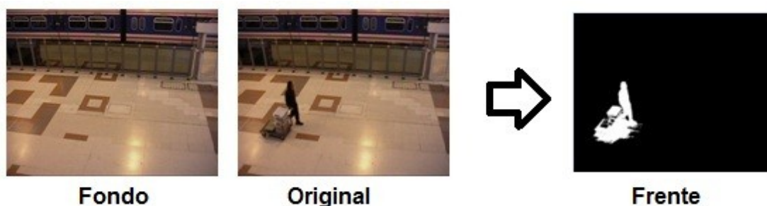
Figura 2-10: Detector de frente basado en diferencia.
