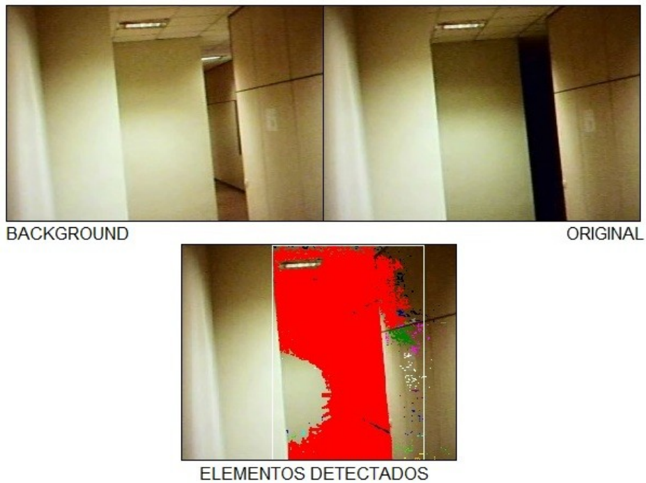
Figura 3-5: Respuesta del sistema ante un cambio de iluminación brusco
