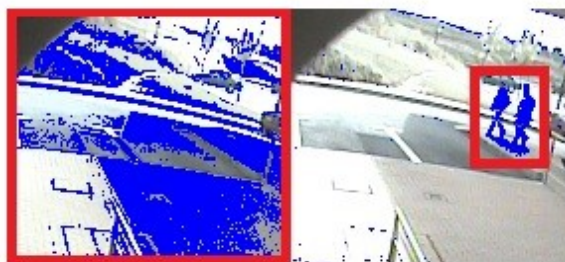
Figura 4-7: Diferencias entre el efecto provocado por cambios de iluminación y la aparición de intrusos en escena
