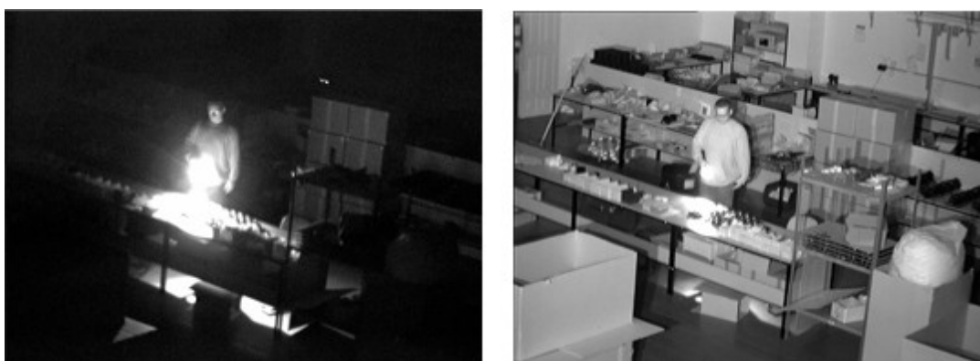
Figura 3-11: Escena grabada con una cámara sin un foco IR infrarroja y con iluminación infrarroja [6].
