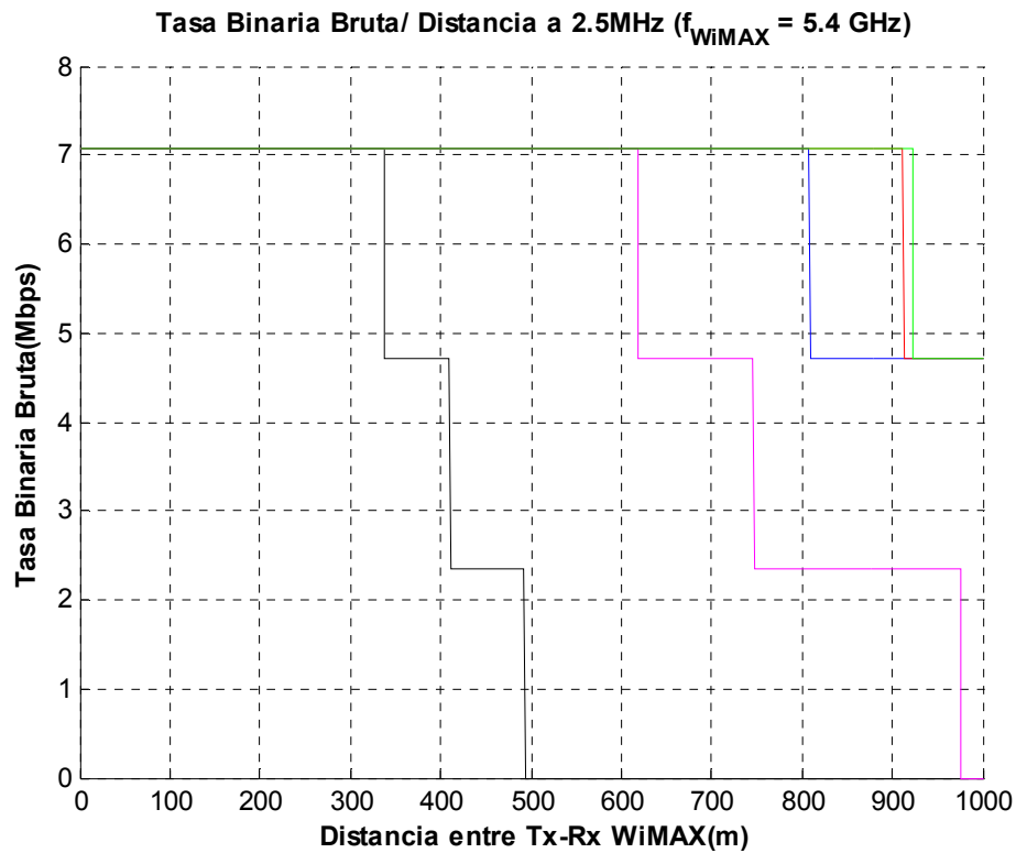
Figura 4.29: Tasa binaria bruta en función de la distancia entre Tx-Rx WiMAX (1m. a 1Km.), con un ancho de banda del canal de 2.5 MHz. Frecuencia central 5.4 GHz y PIRE WiMAX de 58 dBm.
