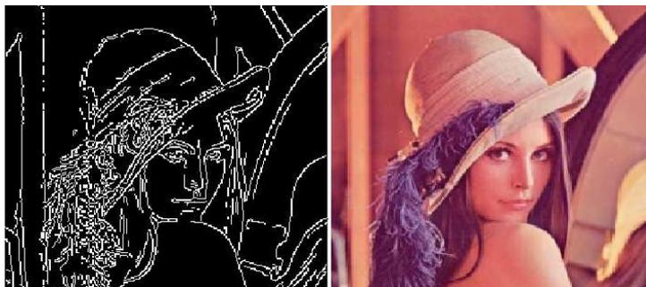
**Figura 2.4** – Resultado obtenido tras la aplicación del detector de bordes Canny [25]
