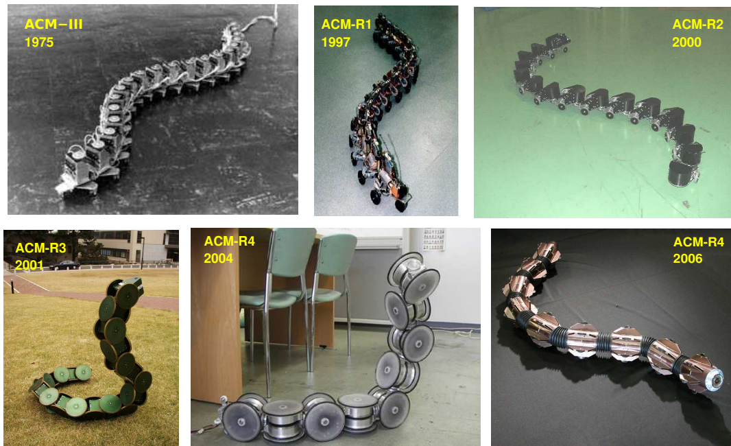
Figura 2.2: Evolución de los robots serpiente de la familia ACM ( Active Cord Mechanism ). Hirose-Fukushima Robotics Lab
