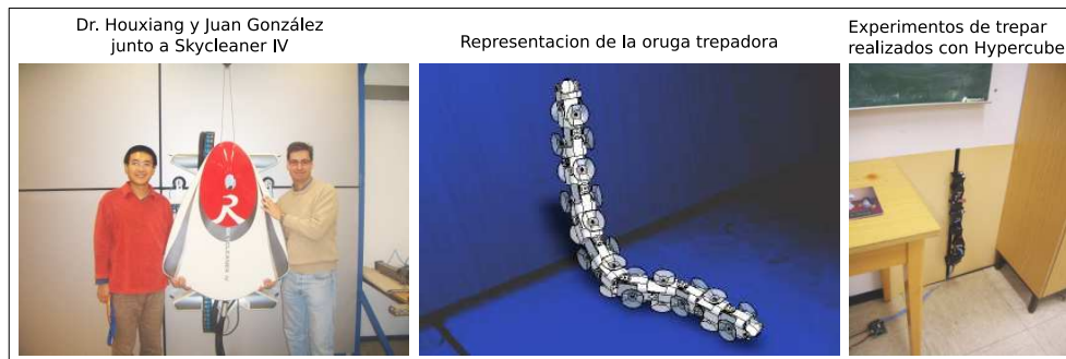
Figura 8.2: Robot trepador Skycleaner (izquierda). Prototipo de la oruga trepadora que usa ventosas pasivas para agarrarse (centro). Experimentos de trepar realizados con Hypercube (derecha)
