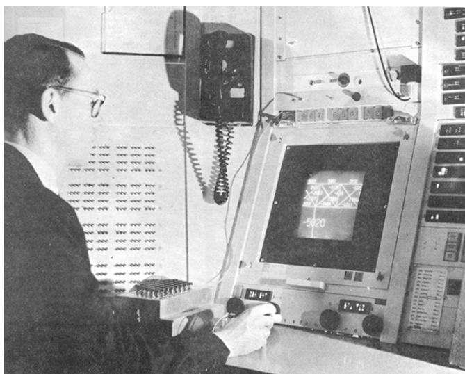
Figura 3.1: Sutherland trabajando con Sketchpad sosteniendo el lápiz óptico. Los botones para usar las distintas funciones de dibujo están en la caja enfrente del autor
