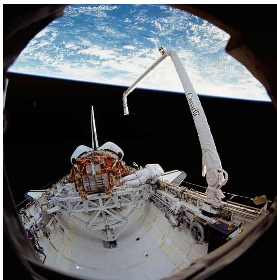
Figura 1.3: Shuttle Remote Manipulator System (SRMS), Servicio Remoto del sistema manipulador o Canadarm
