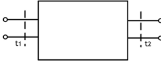
Figura 2-19: Parámetros S, red de 2 puertos.
