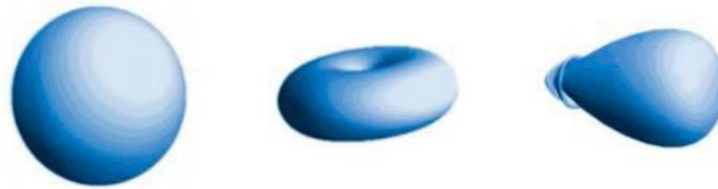
Figura 2-17 Diagramas de radiación: a) Isotrópico b) Omnidireccional c) Directivo
