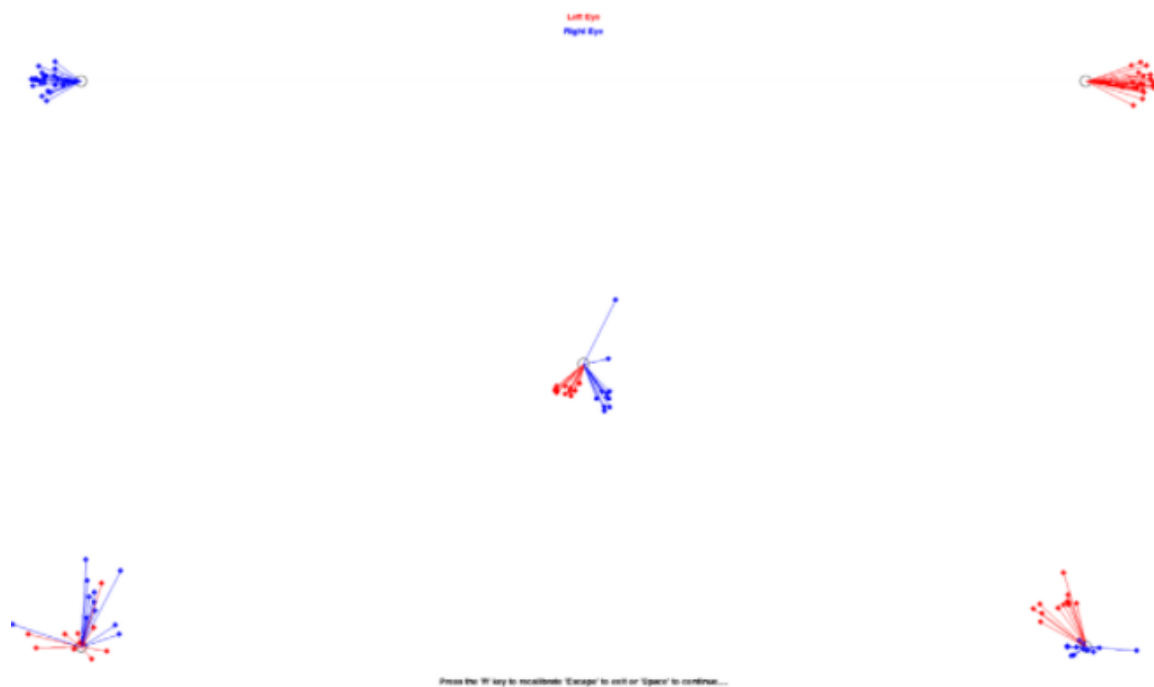
Figura 6. Ejemplo de calibración no aceptable para pasar a la prueba. No se observan tanto puntos rojos como azules en todos los puntos lo que implica que alguno de los dos ojos no ha sido captado por el aparato. Se puede observar una baja precisión (dispersión entre los puntos) de los valores en el punto situado abajo a la izquierda aunque la exactitud general (distancia entre el valor real y los obtenidos) es bastante elevada teniendo en cuenta el tamaño total de la pantalla.
