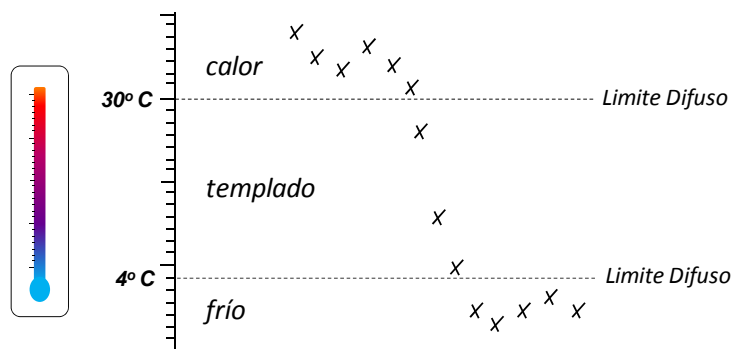
Figura 5: Ejemplo propuesto para la explicación de los límites difusos de los conjuntos de clasificación empleando métodos heurísticos. Se observan dos zonas con alta densidad de población de mediciones, por encima de 30 °C y por debajo de 4 °C, estableciéndose estos límites para los conjuntos de valores que determinan calor y frío. El establecimiento de límites difusos implica que cada observación no se clasifica dentro de un solo conjunto, sino que tiene una contribución que afecta a 2 conjuntos adyacentes: una temperatura de 29 °C puede contribuir con un 60% al conjunto templado y un 40% al de calor, o por otro lado, una temperatura de 0 °C puede contribuir con un 90% al conjunto de frío y un 10% al templado.
