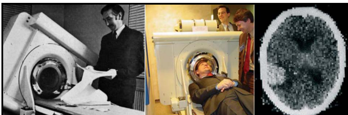
FIGURA 1. Los primeros equipos de TC se introdujeron para uso clínico en 1972. Este fue uno de los primeros TC construido por G. Hounsfield, que todavía se puede ver en la Clínica Mayo, Rochester, Minnesota (USA). El primer TC comercial estaba dedicado a la imagen cerebral, capaz de adquirir imágenes del cerebro con una matriz de 64 x 64 pixels en 7 minutos por corte (Imagen de un equipo Siemens Siretom, 1974). (58) .
