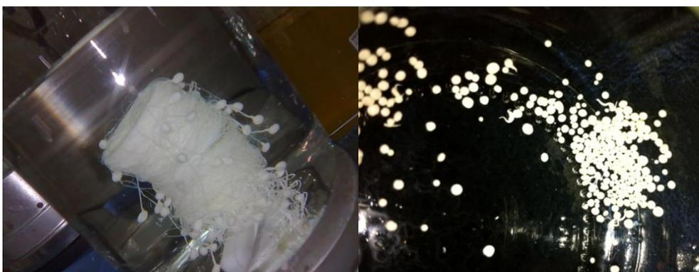
**Figura 8.** Aspecto físico que presentaron las PIs bifenílicas después de su precipitación: PIs derivadas de BFAPB y 4MeBFAPB (izquierda) y 6FDA-6MeBFAPB (derecha).
