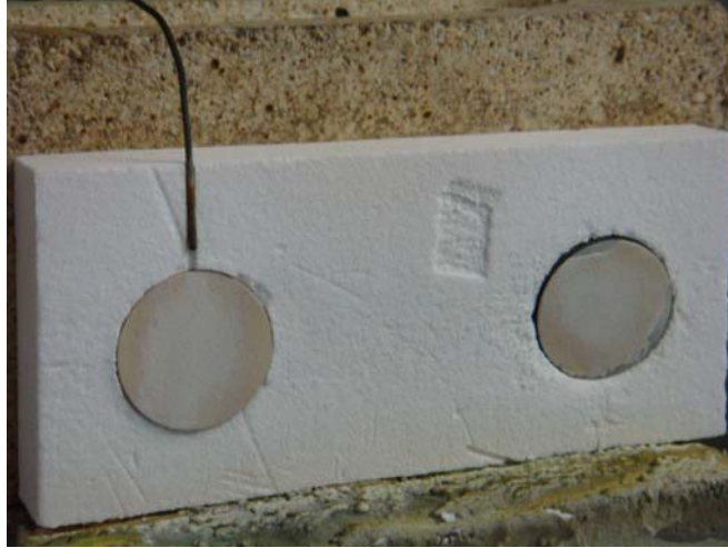
Figura 3.18. Fotografía del sistema de colocación de los recubrimientos PT para el ciclado térmico.
