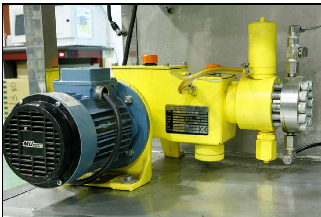
Figura 76. Bomba de alimentación de muestra líquida (Dosapro Milton Roy, Francia).
