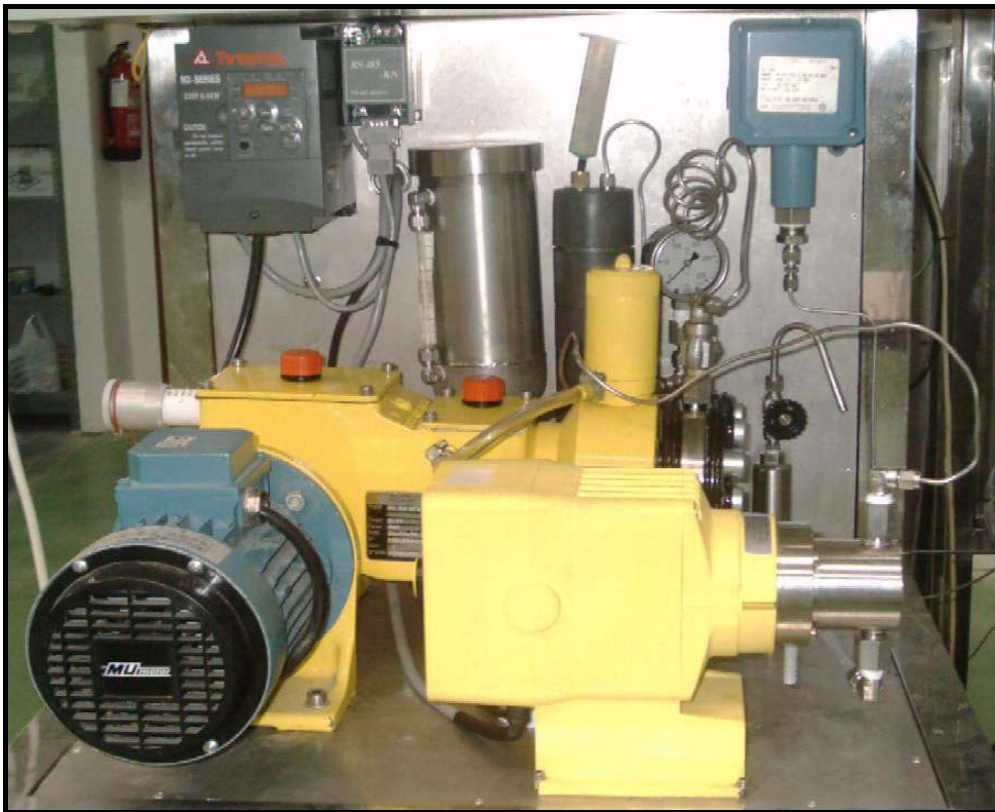
Figura 74. Bomba 1 utilizada para la introducción de CO 2 líquido (Dosapro Milton Roy, Francia). En primer plano se aprecia también la bomba para la introducción de modificador para los casos en los que se requiera su uso.
