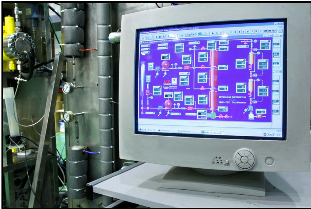
Figura 73. Sistema informático de control de procesos y adquisición de datos en tiempo real.
