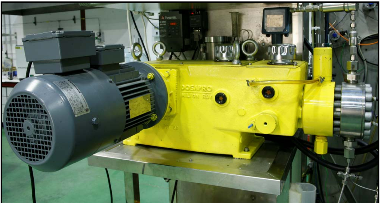
Figura 75. Bomba 2 utilizada para la introducción de CO 2 líquido (Dosapro Milton Roy, Francia).
