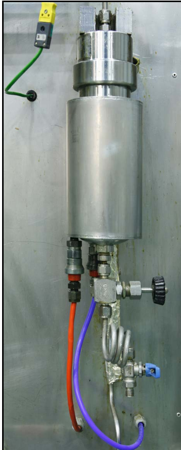
Figura 71. Detalle de un separador donde tiene lugar la descompresión del CO 2 .
