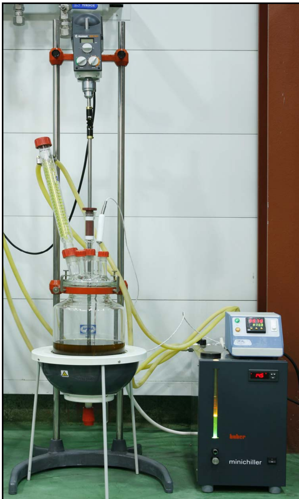
Figura 40. Reactor con tapa de 5 vías y manta térmica (Afora, España), agitador mecánico (Heidolph Instruments, Schwabach, Alemania), controlador para la temperatura (Selecta, Abrera, España) y criostato (Huber, Offenburg, Alemania) que condensa los vapores generados durante la reacción.
