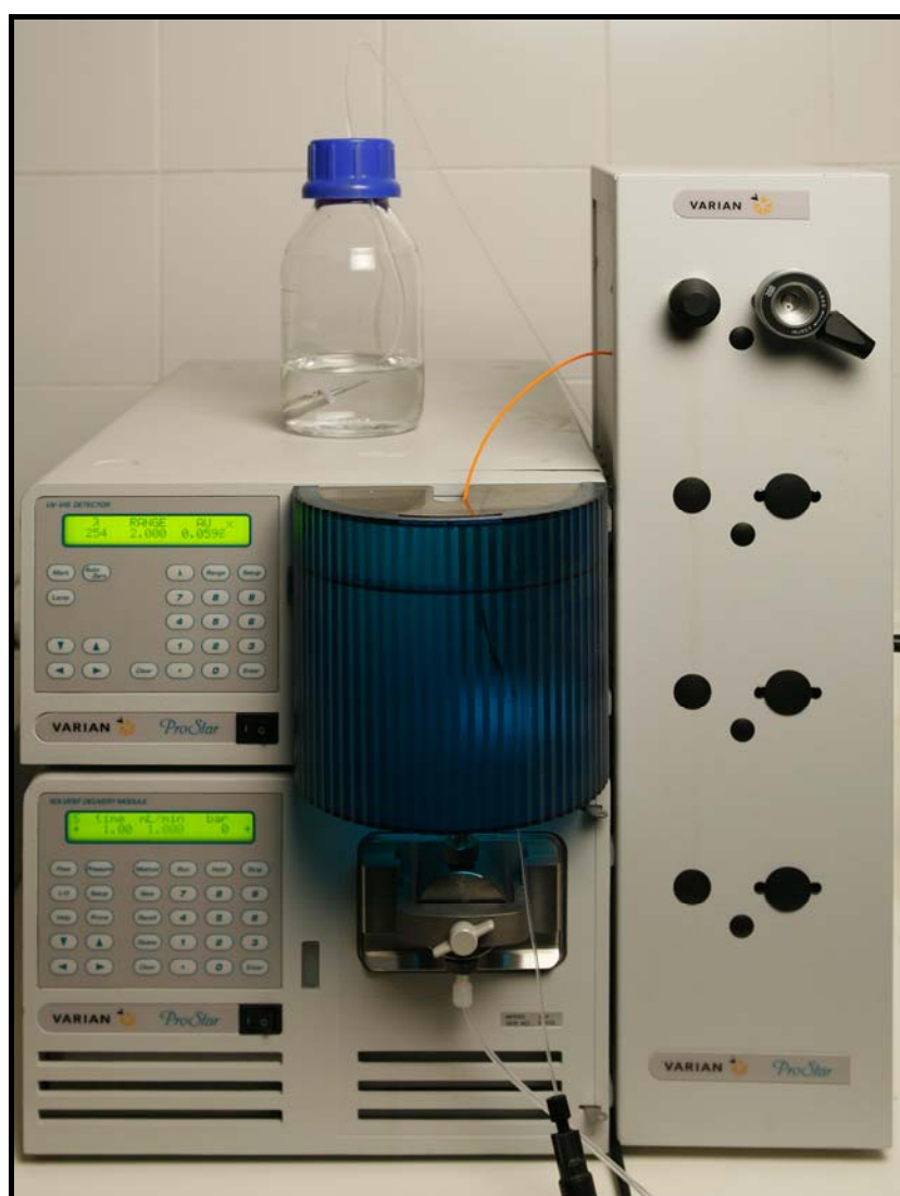
Figura 39. Equipo de HPLC isocrático con detector UV/Vis.
