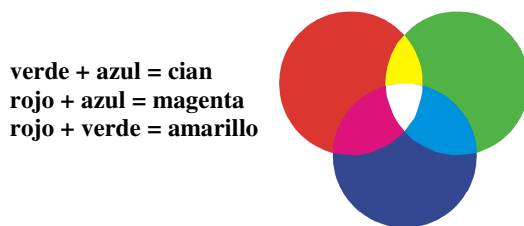
Figura V: Mezcla aditiva de luces
