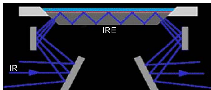
Figura 3. 2. Diagrama esquemático de un sistema ATR, con geometría horizontal de plato hondo, donde se ve reflejada la radiación IR incidente a través del IRE.
