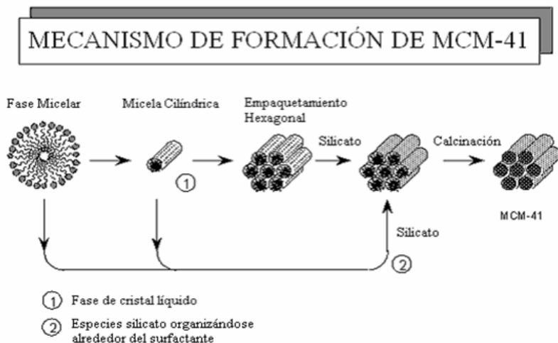
Figura 1. 10. Representación esquemática de la síntesis de MCM-41. Mecanismo propuesto por el grupo de la Mobil
