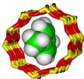
Figura 1. 6. Esquema de los canales de silicalita a través de los cuales puede difundir la molécula p-xileno
