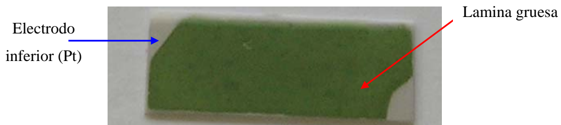
Figura VII.2. Fotografía de una lámina gruesa sinterizada obtenida por serigrafía.
