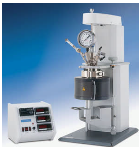
Figura 4.3 Planta de presión de la empresa Parr, empleado en síntesis de nitruros de carbono por método solvotermal.
