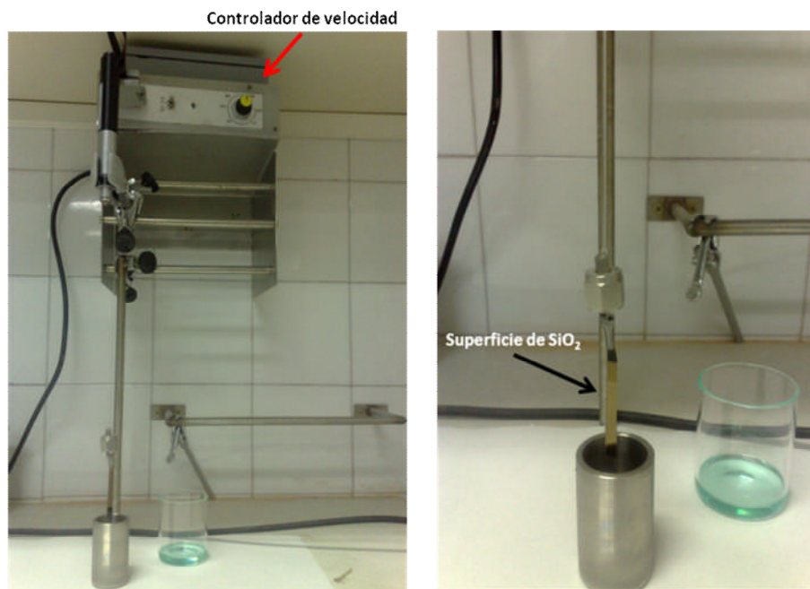
Figura A.8. “Sistema Dip-Coating” o deposición por inmersión a velocidad controlada. En la imagen de la derecha se amplía la zona donde se encuentra la superficie a depositar junto a una disolución ejemplo.
