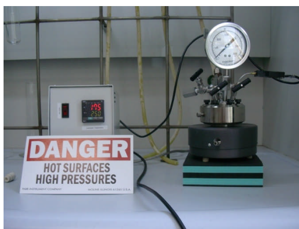
Figura A.1 Reactor de presión modelo 4792 marca Parr utilizado en la síntesis de nitruros de carbono.
