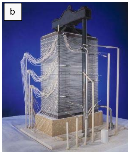
Figura 1.19. SOFC de configuración plana soportada en el ánodo de FZJ. a) Configuración con distribuidores internos de gases y flujo de gases en paralelo, b) SOFC de 60 celdas y 13.3 kW de potencia con H_2 como combustible
