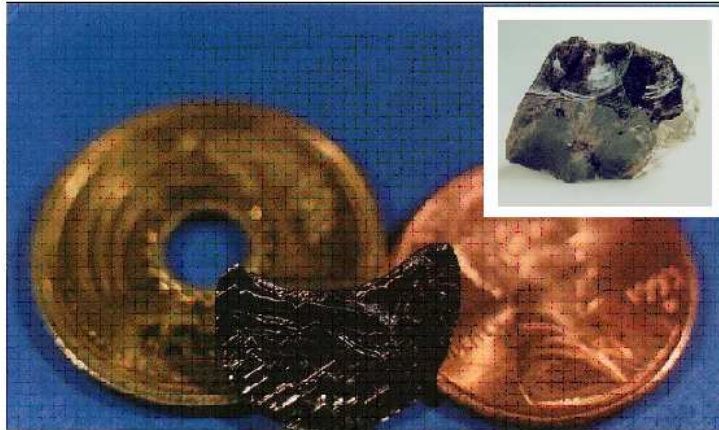
Figura 2.1: Fractura concoidal en una muestra de LuNi_2B_2C [Canfield98].
