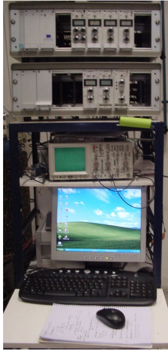
Figura 2.10: Sistema de control del STM: Unidad de Control, osciloscopio y el ordenador personal.
