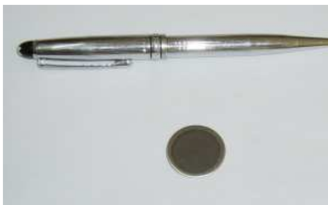
Figura 9.2. Disco de acero inoxidable en el que se realizó la electrodeposición del uranio.
