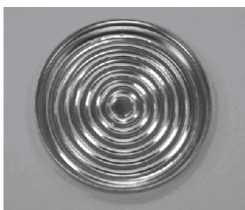
Figura 2.4. Plancheta beta de acero inoxidable utilizada en la preparación de muestras para la determinación la actividad de los diferentes emisores alfa.
