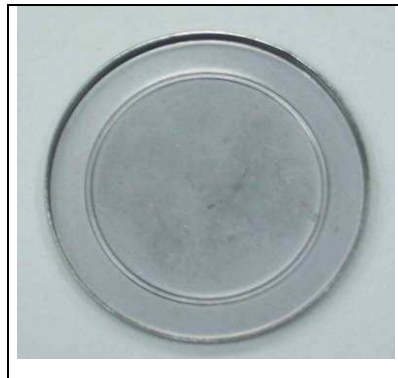
Figura 2.1. Plancheta alfa de acero inoxidable utilizada en la preparación de muestras para la determinación del índice de actividad alfa total.
