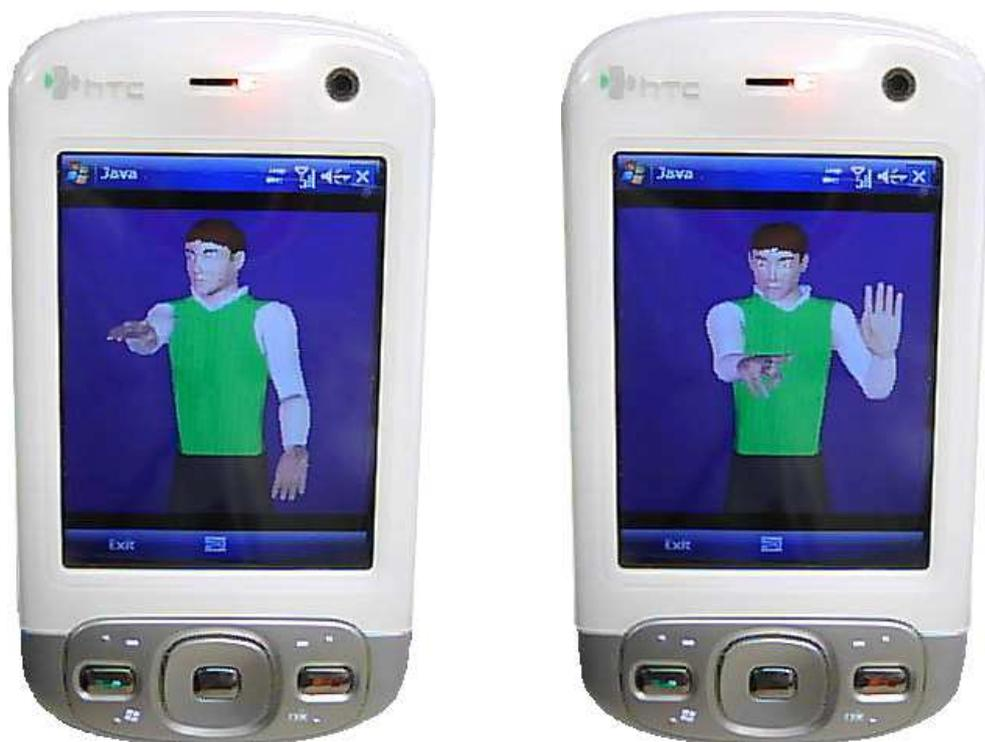
Figura 14.2: Aplicación diseñada para la visualización de ficheros «m3g» en una PDA.
