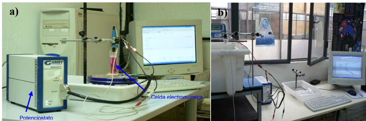
Figura 4. Montaje experimental empleado para los ensayos electroquímicos. a) dispositivo común para realizar los ensayos a temperatura ambiente, b) dispositivo empleado en la presente tesis.
