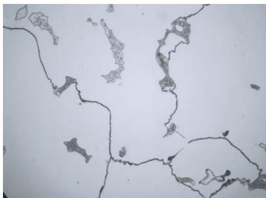
Figura 1. Micrografía óptica de la aleación de CoCrMo. Preparación metalográfica realizada en una disolución de persulfato amónico a 5 V durante 10 segundos (x 1000 aumentos).
