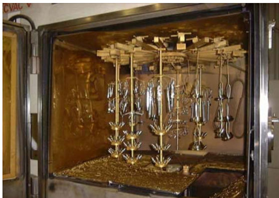
Figura 3. Vista del interior del reactor de PVD empleado para realizar los tratamientos de modificación superficial sobre la aleación de CoCrMo.
