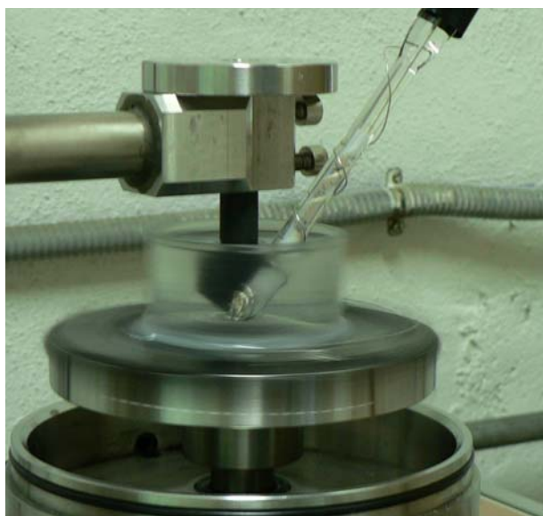
Figura 6. Detalle del montaje experimental de la celda electroquímica en el ensayo de tribocorrosión.
