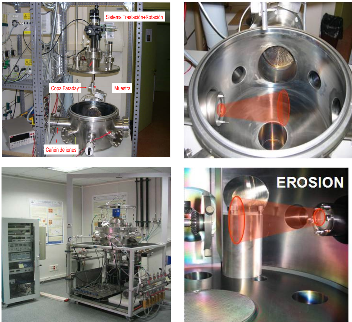
Figura 2.1: Fotografías de los equipos experimentales de baja energía (IBS) utilizados en este trabajo. Fila superior: sistema experimental en el ICMM-CSIC equipado con una fuente de iones ACC-IS. Fila inferior: sistema utilizado en el CMAM-UAM con una fuente de iones tipo Kaufman.
