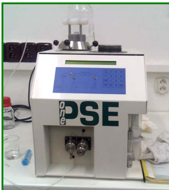
Figura VI.3. Imagen del equipo de extracción con líquidos presurizados (PSE-one, Applied Separations) utilizado en este trabajo.
