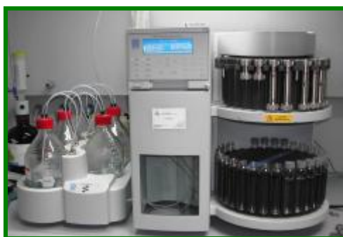
Figura II.3. Imagen del equipo de extracción con líquidos presurizados (ASE 200, Dionex) utilizado en este trabajo.
