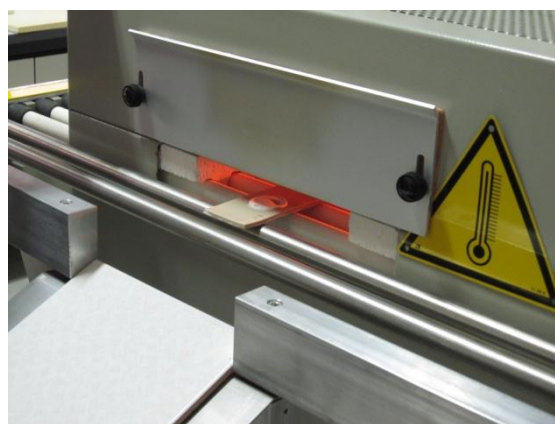
Figura 7.4. Salida de las plaquetas del horno.
