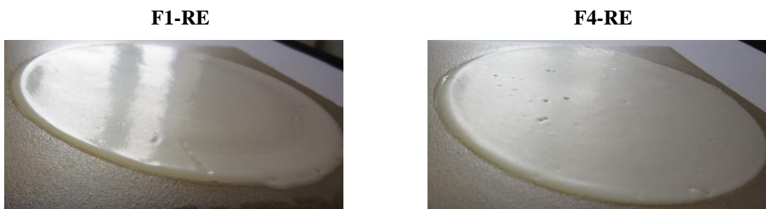
Figura 7.46. Fotografías de los vidriados F1-RE y F4-RE después de la abrasión, observadas con cierto ángulo.
