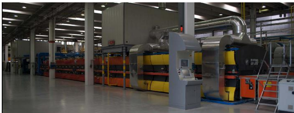
Figura 1.5. Horno de rodillos de la planta piloto de SACMI S.C. (Imola, Italia).
