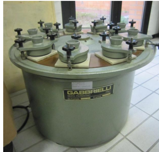
Figura 3.11. Máquina para ensayo PEI (9 muestras).
