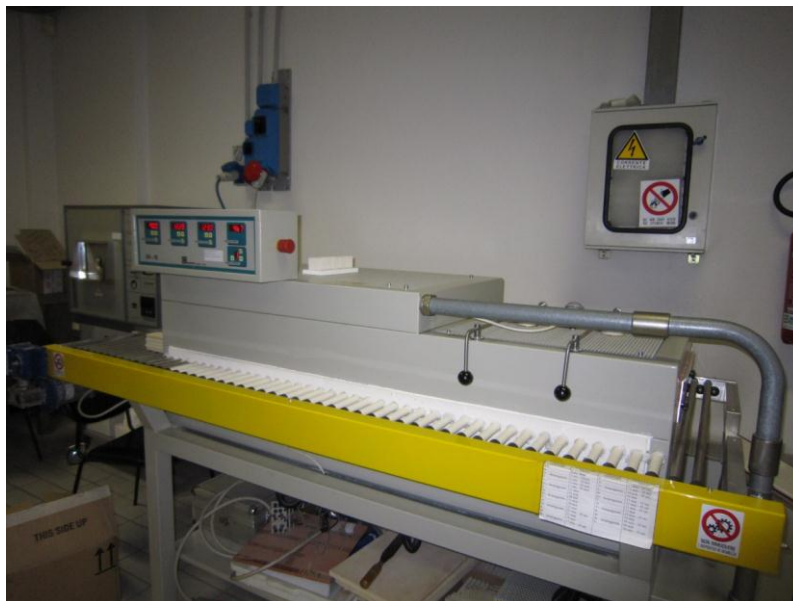
Figura 7.2. Horno de rodillos utilizado en las pruebas previas de cocción de soportes de gres porcelánico recubiertos con barbotinas de las fritas FE y RE.
